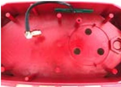
Bitte die Antenne unbedingt auf der hier abgebildeten Seite montieren, da die Kabellänge anderenfalls nicht ausreicht.
